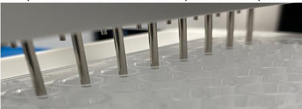
Die Waschköpfe bestehen aus chemisch widerstandsfähigem POM (Polyoxymethylen) und Edelstahlrohren aus dem 316er-Stahl für Langlebigkeit und einfache Reinigung mit Lösungsmitteln, falls erforderlich. Wählen Sie aus 2 verfügbaren Waschköpfen: 8-Kanal- und 12-Kanal-Waschköpfe. Die präzise Steuerung der Waschkopfpositionierung gewährleistet minimale Flüssigkeitsrückstände nach dem Absaugen (<1ul/Vertiefung) und verbessert die ELISA-Ergebnisse.
