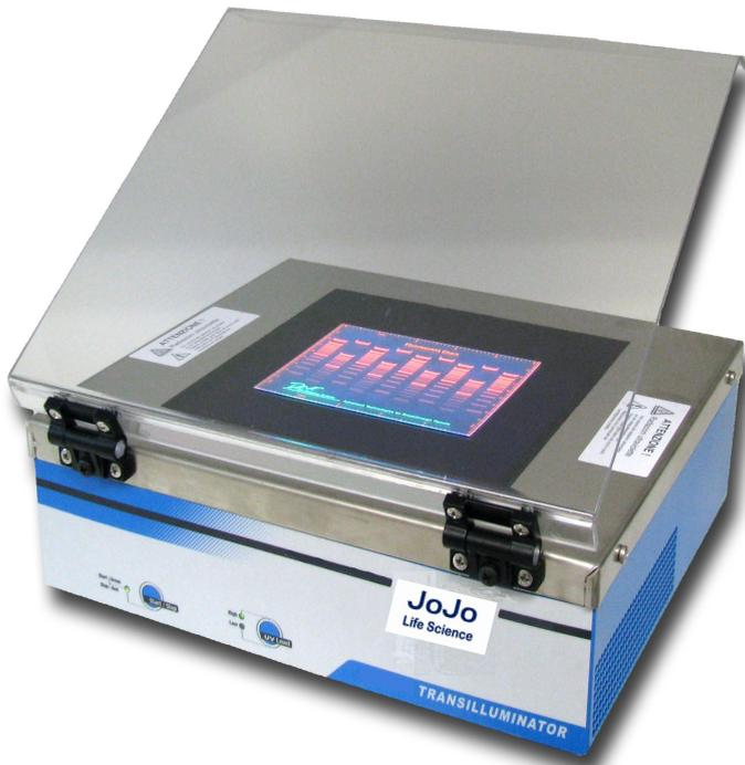
Die JoJo-UV-Transilluminator-Serie bietet dem Forscher gleichmäßiges und intensives ultraviolettes Licht auf einer kompakten Grundfläche. Ihr spezielles Design emittiert eine intensitätsangeregte UV-Wellenlängen für die Hintergrundbeleuchtung von transparenten fluoreszierenden Materialien. 254 nm, 312 nm und 365 nm, sind für verschiedene Anwendungen verfügbar.
