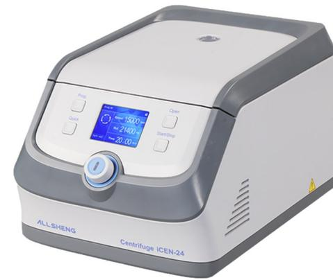
Die gekühlte Zentrifuge iCEN-24R verfügt über eine hochmoderne Kühlfunktion, die Energieeffizienz und hohe Temperaturgenauigkeit für maximalen Probenschutz gewährleistet. Temperaturregelbereich -10°C bis 40°C; 4°C können auch bei höchster Drehzahl gehalten werden. Im statischen Vorkühlmodus beginnt der Kompressor automatisch zu kühlen, wenn der Zentrifugendeckel geschlossen wird.
