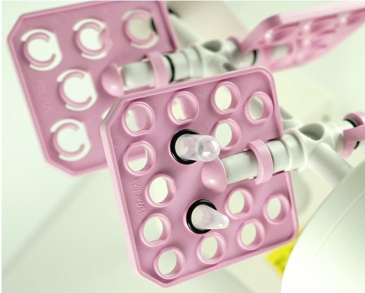
Der Tube Revolver kann in einer Vielzahl von Laborbereichen eingesetzt werden, z.B. in der Molekularbiologie, der Biochemie, der klinischen und der Histochemie. Die Rotisserie ist austauschbar, so dass das Gerät mit einer Vielzahl von Röhchengrößen arbeitet. Die vier Rotisserie-Paddel können für eine Kombination von verschiedenen Röhren gemischt werden. Die Richtung jedes Paddels kann unabhängig voneinander von 0-90 Grad eingestellt werden.
